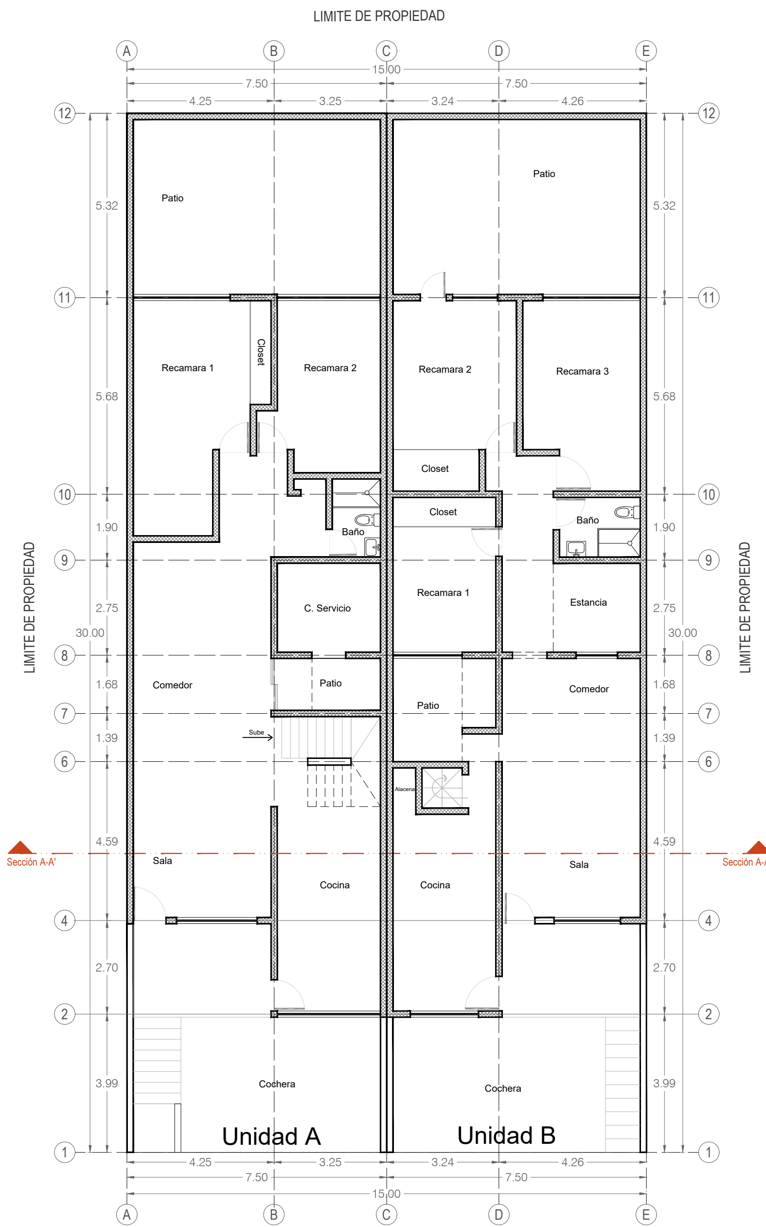
01 Planta Baja - Estado Actual Escala 1:100
